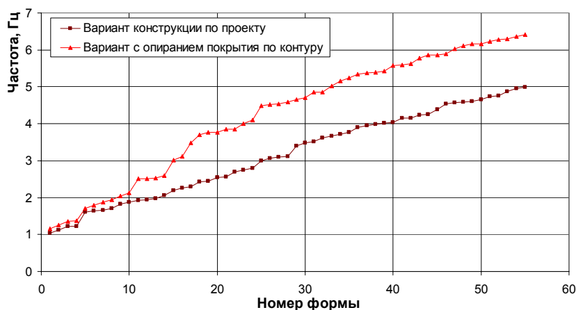
Рис. 6. Низшие частоты собственных колебаний покрытия Центрального стадиона
